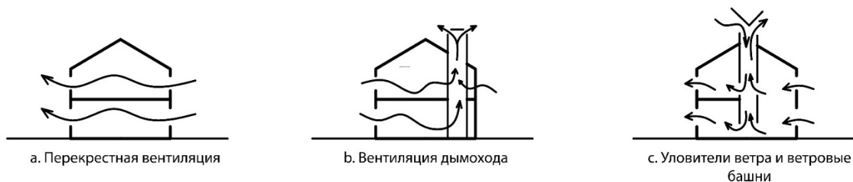
Рис. 1 Основные модели естественной вентиляции
