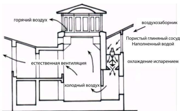
Рис. 3 Испарительная система воздушного охлаждения в Египте. естественное охлаждение в
